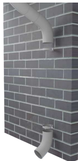
Rozplanowanie obejm rury spustowej
